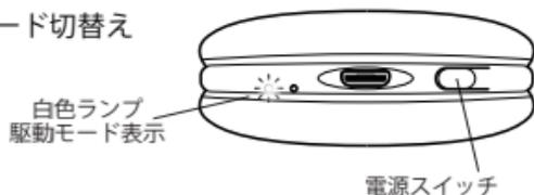
電源スイッチの操作で、以下の順に駆動モードが切り替わります。
