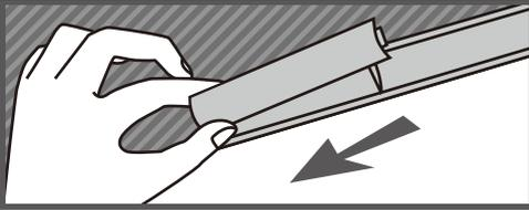
2. Inserte 4 pilas alcalinas AA nuevas (2 a la izquierda y 2 a la derecha)
